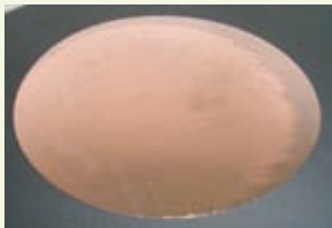
φ160mm 300μm銅電鍍板
